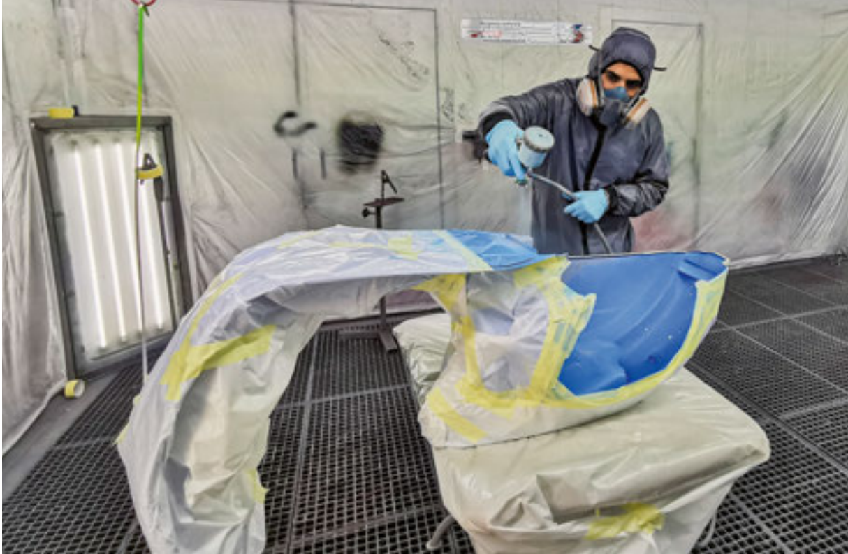
In der Spritzkabine wird der beim Lackieren entstehende Farbnebel abgesaugt und gereinigt; gleichzeitig wird dadurch verhindert, dass Staub oder Schmutz in die Lackschicht gerät.
